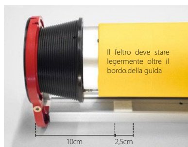
Posizione del feltro smorzante sulla staffa a muro e sulla guida della staffa per il montaggio a parete e a soffitto
